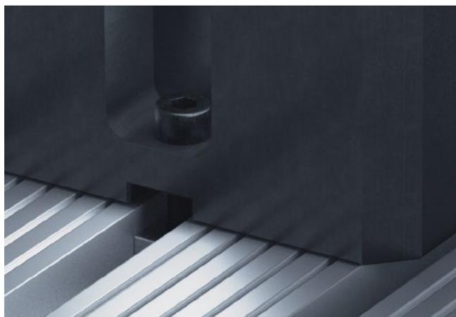
Si la structure inférieure doit rester en permanence sur la table de la machine, une fixation directe dans les rainures de la table de la machine apparaît comme la meilleure solution. Dans ce cas, il est possible d'économiser une plaque point zéro et sa hauteur de montage de 27 mm.
