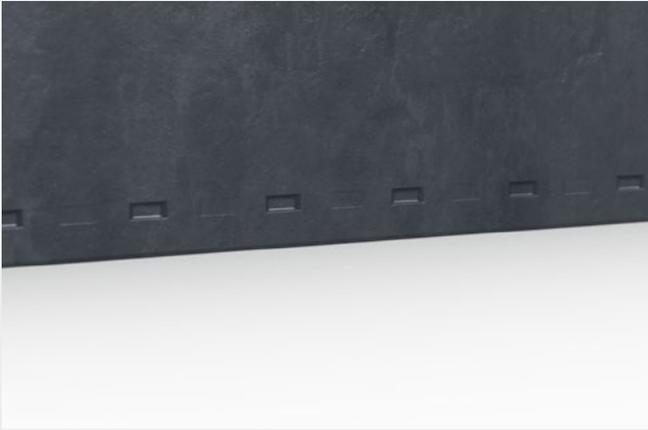
Les empreintes de maintien et celles de contrôle sont clairement visibles. La profondeur des empreintes de contrôle (témoins de marquage) doit être d'environ 0,05 mm. La profondeur des empreintes de maintien est ainsi d'environ 0,20 mm.
