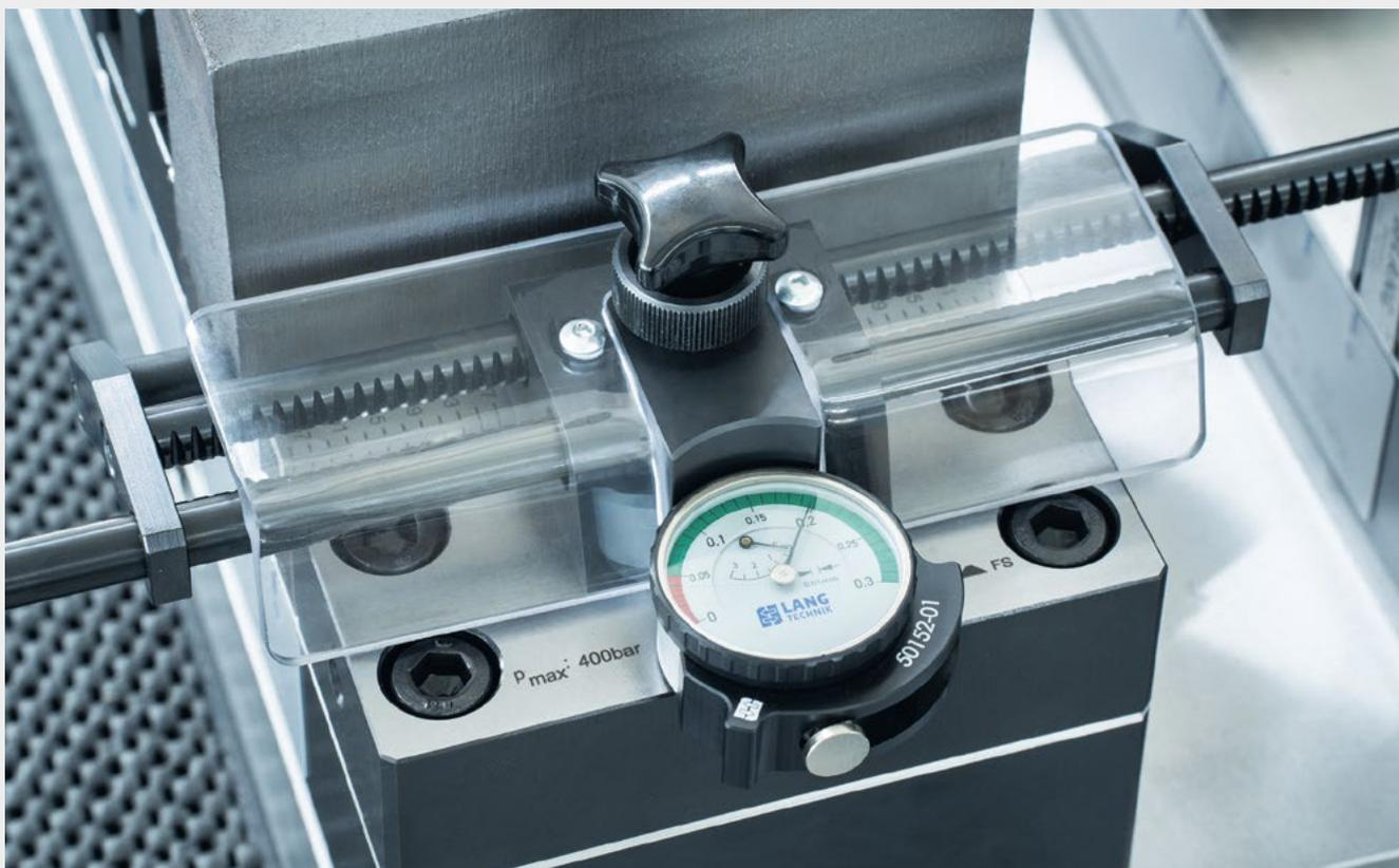
La pression de marquage est réglée à l'aide de la valve de régulation de la pression sur la station de marquage. Le tableau ci-dessous indique la profondeur de marquage correcte pour différentes résistances à la traction. Il est valable pour les deux variantes (Makro-Grip® et Makro-Grip® FS).
