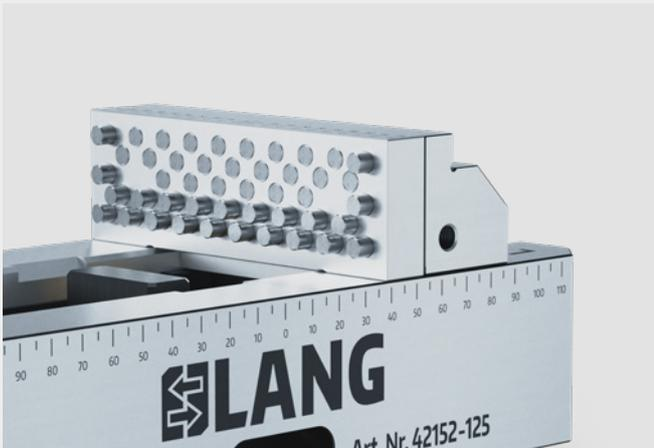
Les pions non nécessaires sont simplement repoussés à la main. Les pions restants servent de possibilité d'arrêt et de support pour la pièce à usiner. Les supports parallèles ou les butées de pièces
