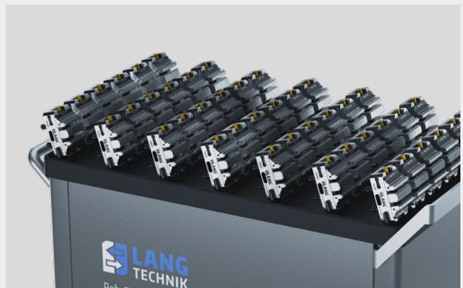
L'utilisation de mors centraux dans l'étau 5 axes Makro·Grip® permet d'accroître la capacité de stockage du système d'automatisation RoboTrex.
