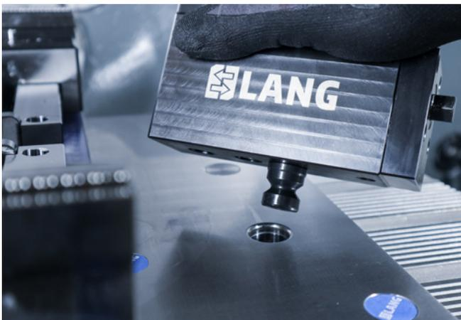
Le Hydro·Sup est fixé à l'aide de son pion de positionnement, comme d'autres éléments de serrage de LANG dans le système de serrage à point zéro Quick·Point®.
