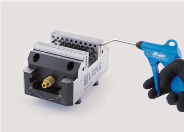
Afin de garantir la fonction des pions à tout moment, ceux-ci doivent être soufflés et nettoyés à l'air comprimé à la fin de chaque session d'usinage afin d'éviter un grippage causé par le réfrigérant. D'autre part, nous conseillons d'appliquer régulièrement une huile multifonctions sur les pions.
