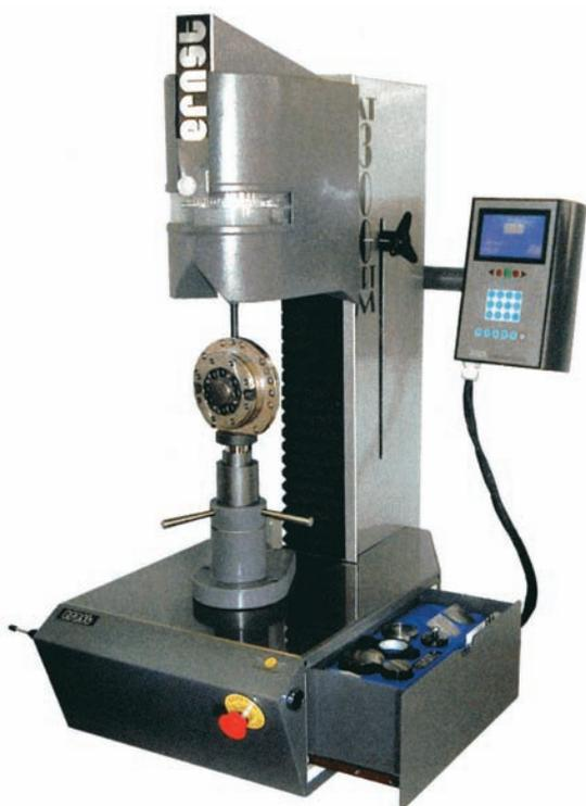
Basé sur le principe Rockwell, l'application de la précharge et de la charge est automatique grâce à une motorisation intégrée.
