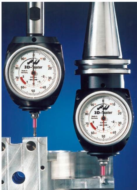
Permet de déterminer le point zéro d'une pièce à usiner
