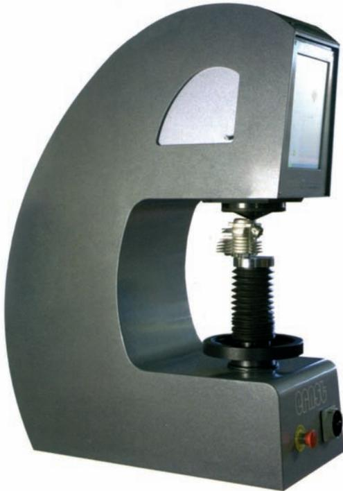
L'Omnitest permet des essais sous les charges de 9,80 N à 2451 N (1 à 250 KgF). La sélection du type d'essai ainsi que la sélection des charges est rapide et simple.
