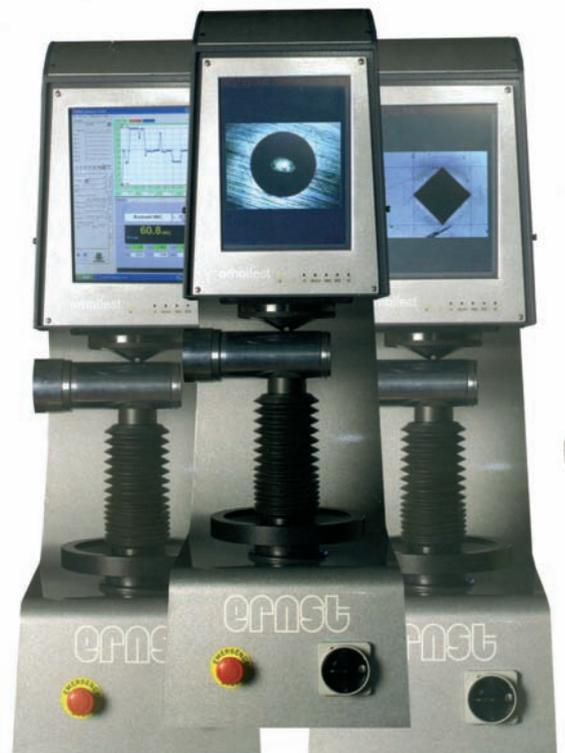
Duromètre universel Omnitest
