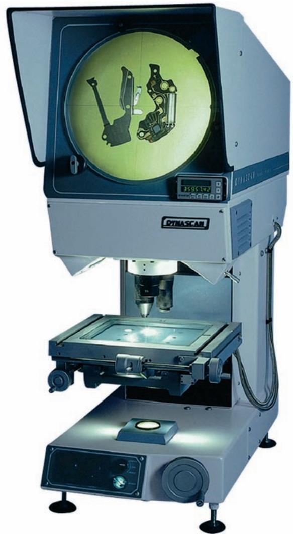
Ces mesures sont immédiatement affichées en temps réel sur un graphique dans lequel peuvent s'afficher distances et angles permettant de coter les éléments géométriques créés.
