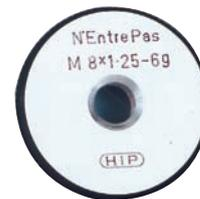
Chaque tampon et bague est numéroté et fourni avec certificat de contrôle du constructeur
