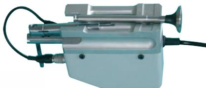
Mesure d'une pièce posée sur l'unité, palpeur à 180°
