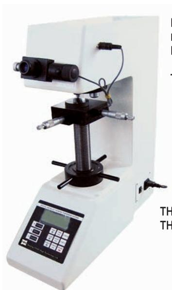
Mesure optique de l'empreinte et validation de la mesure des diagonales.
