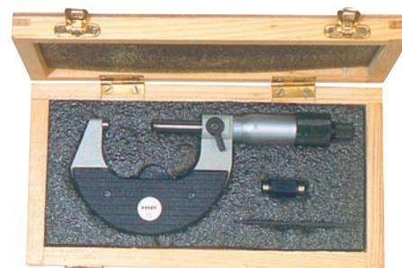
Livrés en coffret bois avec clé, mode d'emploi, étalon de réglage (à partir de la capacité 25-50)
