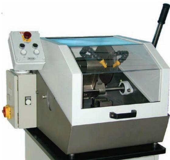
Tronçonneuse en acier inox, carter de protection en plexiglass, passage de barre latéral, liquide de refroidissement contenu dans un bac en inox placé dans la base de la machine. Nombreux accessoires en option.
