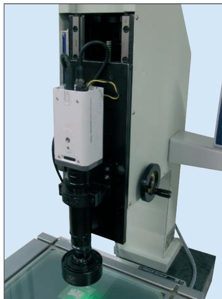
La table et la coulisse verticale sont guidées par rails largement dimensionnés. Le tout est fixé sur un marbre en granit de 100 mm d'épaisseur, assurant à l'ensemble une grande rigidité.
