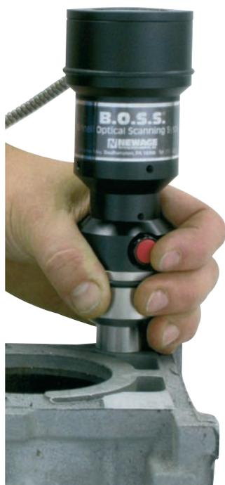
Le système B.O.S.S. permet de mesurer le diamètre des empreintes Brinell avec rapidité et précision. Il remplace les microscopes utilisés habituellement et offre d'autres avantages : mesure plus précise, plus rapide, sans fatigue pour l'opérateur, avec possibilité de stocker les résultats en vue d'analyses statistiques etc.
