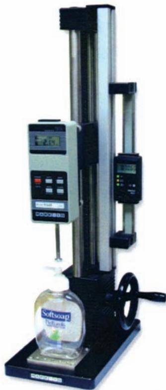
Le banc ES 30 pour essais en traction et compression est adapté pour toutes les mesures usuelles en atelier ou laboratoire
