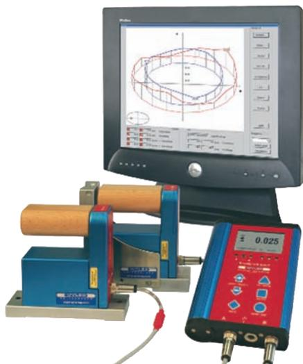
Le BlueSYSTEM BASIC se compose généralement d'un ou deux instruments de mesure BlueLEVEL BASIC et d'un afficheur BlueMETER BASIC. L'afficheur peut-être relié à un PC avec un logiciel pour présenter et analyser les résultats des mesures. La connexion des différents éléments du BlueSYSTEM BASIC se fait par câbles. Ce système permet le contrôle de la géométrie des marbres et de toutes sortes de machines.
