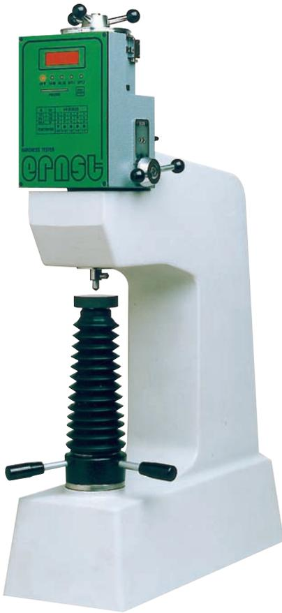
Le duromètre NR3 D fonctionne selon le principe Rockwell avec précharge et charges normalisées.
