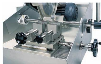
TR60 équipée d'un étiau double serrage et du système de translation latérale course 136 mm
