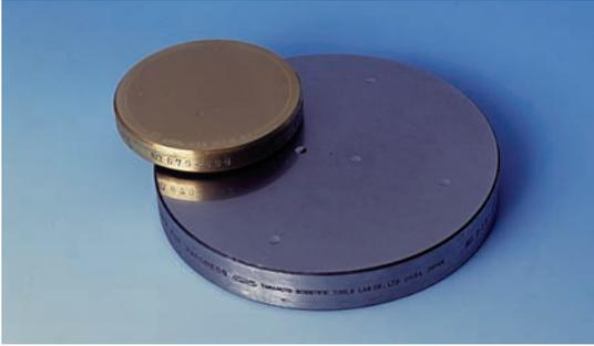
Pour vérification du bon fonctionnement des machines d'essai de dureté des métaux en conformité avec les normes.
