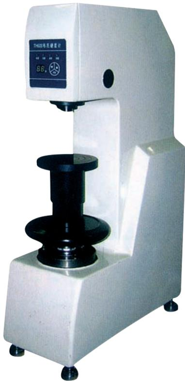
Les différentes charges d'essai sont obtenues par empilage de masses à l'arrière de l'appareil.
