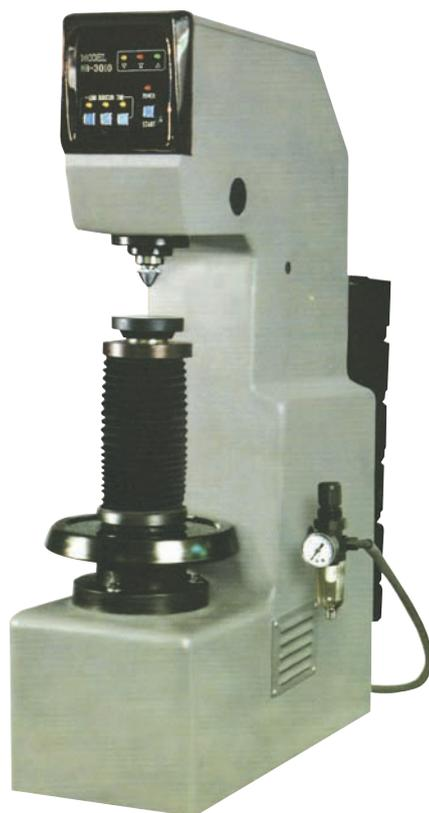
Les différentes charges d'essai sont obtenues par empilage de masses à l'arrière de l'appareil.
