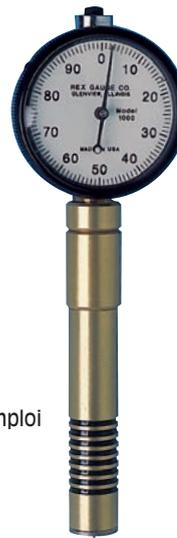
Un système de blocage automatique de l'aiguille, permet de mémoriser la dureté maxi.
